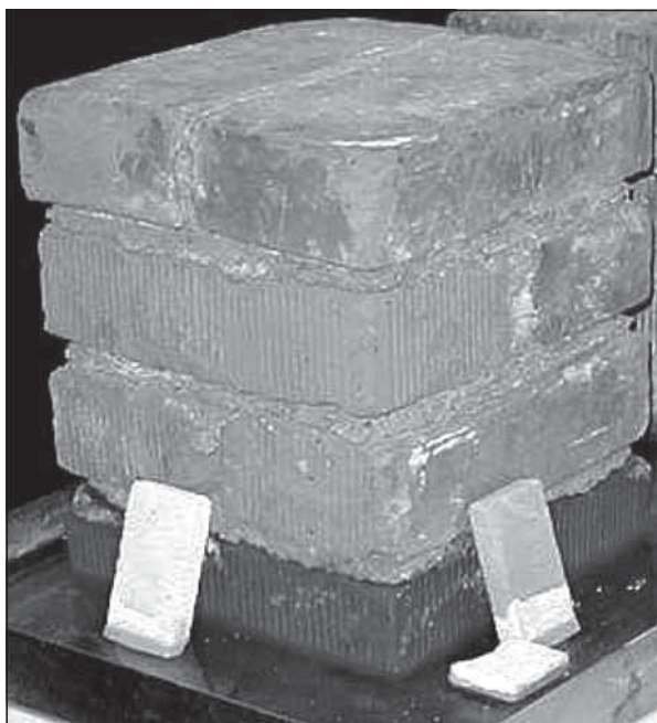
Фото 3. (з виставки по охороні пам'яток, Ляйтціт, 2004). Фірма, яка пропонує гідроізоляційні матеріали, вирішила наглядно продемонструвати зволоження стін підсмоктуванням води, поставивши у водяну ванну стовпчик цегляної кладки. Але протягом 5 днів виставки волога так і не піднялася вище першого ряду цеглин.
