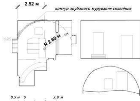
Іл. 24. Розгортка тильної стіни з нанесеним контуром втраченого склепіння. Креслення автора, 2016 р.
